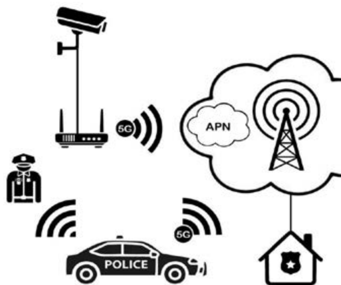
↑ Schéma bezpečnostní datové sítě Bílina (propojení kamer, tělových kamer strážníků, kamer ve vozidlech MP a radarů pro měření rychlosti s operačním střediskem MP a datovým centrem města Bílina)
